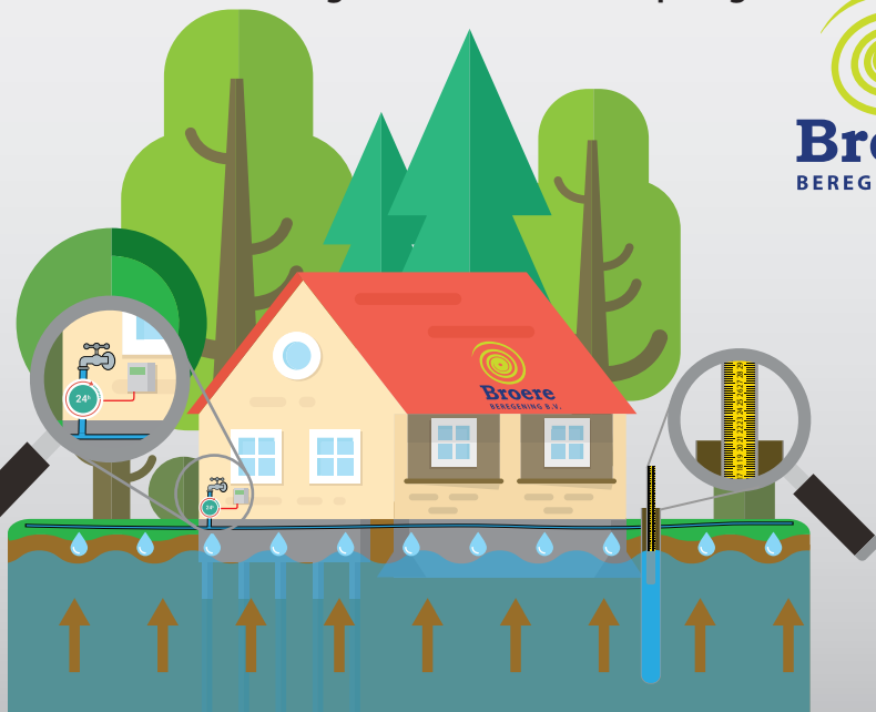
Automatische aanpassing grondwaterpeil door middel van geautomatiseerde drip irrigatie
